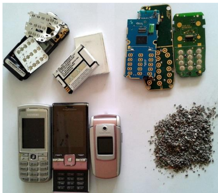
Figura. 1. Desmantelamiento y desarme de teléfonos móviles para obtener las scraps y finalmente un triturado de particulado tamizado entre 2 – 0,2 mm.
