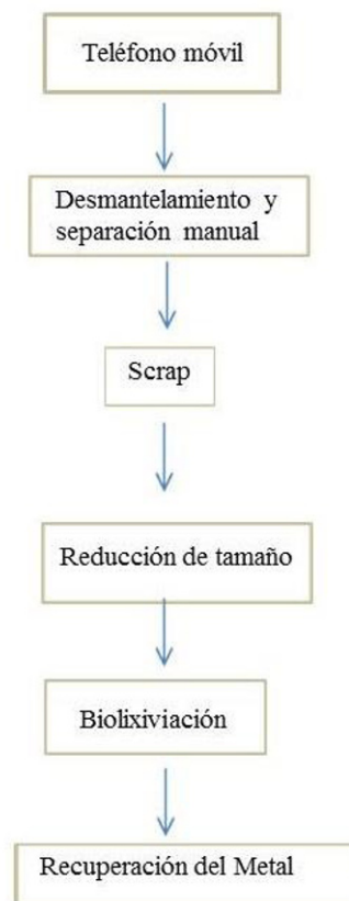
Figura 2. Diagrama del proceso de biolixiviación de scraps de teléfonos móviles.
