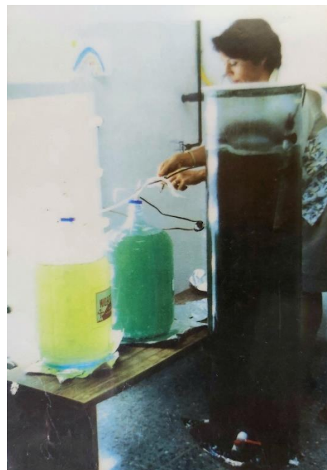
Figura 2. Fotobioreactor "air lift" en la Escuela de Ciencias Biológicas de la UNA.
