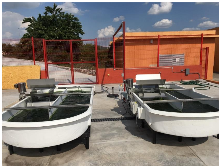
Figura 1. Laguna algal de alta tasa (HRAP) utilizada para el tratamiento de aguas residuales.
